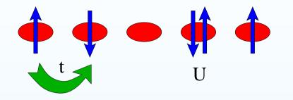
$$\mathcal{H}_{t-U} = t \sum_{\langle i,j \rangle,\sigma} c_{i,\sigma}^{\dagger} c_{j,\sigma} + \frac{U}{2} \sum_{\sigma \neq \sigma'} \sum_{i} n_{i,\sigma} n_{i,\sigma'}.$$
